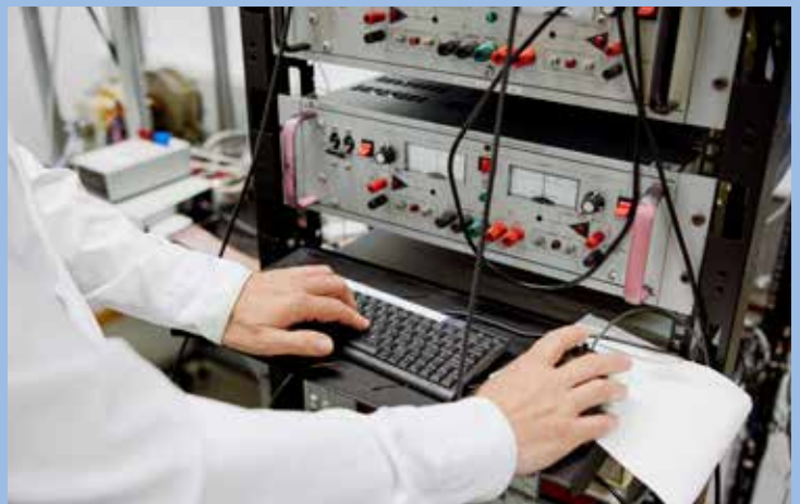
Spitzenforschung für Toyota & Co: Thomas Schrefl untersucht an der magnetischen Messapparatur (links) die Magneteigenschaften einer eingespannten Materialprobe. Die Auswertung findet am Mess- und Steuerplatz (rechts) statt.
